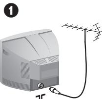
Podłącz wtyczkę antenową do gniazda **T** z tyłu odbiornika.
