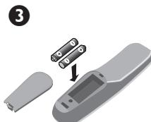
3 Вставьте в пульт дистанционного управления 2 батарейки типа R6, которые поставляются вместе с телевизором. Батарейки должны быть установлены с правильной полярностью.
