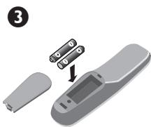
Vložte 2 baterie typu R6, které jsou přiloženy, a respektujte přitom jejich polaritu.
