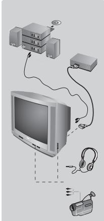
Utiliser la prise péritel située à l'arrière du téléviseur ou les prises AV en façade (si disponibles). Certaines versions sont équipées de 2 prises péritel (EXT1 et EXT2). Pour sélectionner l'appareil connecté, appuyez successivement sur la touche **(**). La plupart des appareils réalisent eux même la commutation (magnétoscope, ...).
