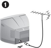
Stop de stekker van de tv-antenne in de **TG**-aansluitbus aan de achterkant van het toestel.
