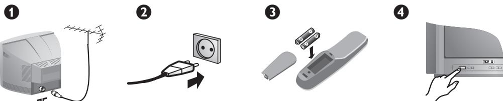
Introduzca el conector de antena de televisión en la toma **TV** situada en la parte trasera.
