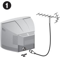
Sett antennestøpelet inn i kontakten
