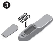
Inserire le due pile di tipo R6 (fornite) facendo attenzione alla polarità.
