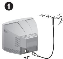
Stecken Sie den Stecker des Antennenkabels in die auf der Rückseite des Fernsehgeräts befindliche Antennenbuchse (图).
