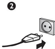
Stecken Sie den Netzstecker in eine Netzsteckdose (220 - 240 V/50 Hz).
