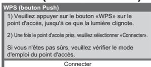
Appuyez sur le bouton WPS du point d'accès jusqu'à ce que la lumière clignote. Appuyez alors sur le bouton OK pour connecter l'adaptateur réseau sans fil et le point d'accès.
