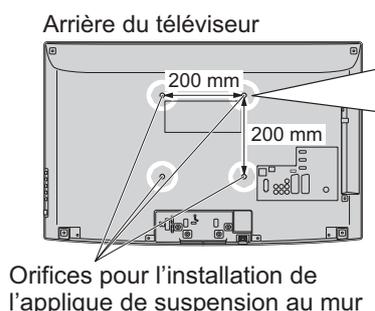
Vis de fixation du téléviseur sur les appliques de fixation au mur (non fournies avec le téléviseur)
